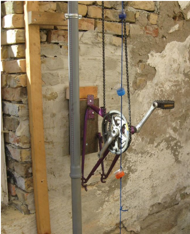
Die Kurbel zum einfacheren Betätigen der Seilpumpe.
